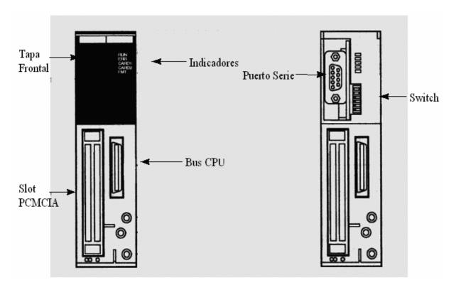
Levantando la tapa frontal del módulo se accede a los switches de configuración de la tarjeta y a un puerto RS232C que será el utilizado en la transferencia del software de configuración del módulo.
