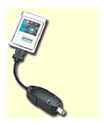
Las tarjetas Ethernet utilizadas con los módulos PCU01 trabajan con drivers DOS ODI. Actualmente existe en el mercado dos versiones de este driver: SPEC3 y SPEC4. El módulo PCU01 sólo soporta tarjetas que trabajan con el driver SPEC3 ODI. En concreto, las dos tarjetas Ethernet PCMCIA chequeadas con autómatas de la serie Alpha, así como los drivers utilizados para cada una de ellas se describen a continuación:
