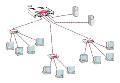
En caso de que algún nodo caiga la red queda intacta, excepto el nodo caído. Si cae la conexión de algún Hub, la subred afectada se separaría de la red principal.
