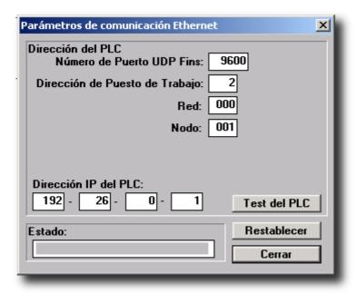
En esta ventana establecemos el puerto UDP utilizado por el PLC (por defecto 9600) la dirección del puesto de trabajo (workstation) o PC , El numero de Red , El numero de nodo del PLC y por ultimo el IP del PLC. Con Test del PLC probaremos la comunicación con el PLC.
