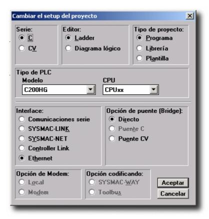
Después de seleccionar nuestro modelo de PLC (C200HG). En la sección Interface seleccionar Ethernet, Y aceptar los cambios. Después configuramos el nodo con el que queremos comunicarnos dentro de "Proyecto/Comunicaciones" :
